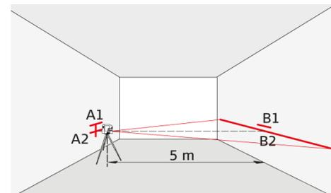
A continuación, coloque el instrumento a la misma altura lo más cerca posible de la pared A y marque otra vez la línea láser horizontal o el punto láser en la pared A (A2). Gire el instrumento 180° de nuevo y marque el láser en la pared B (B2). Mida las distancias de los puntos marcados A1-A2 y B1-B2. Calcule la diferencia de las dos mediciones.
