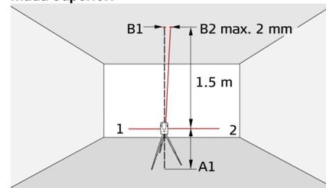
Coloque el interruptor de bloqueo en la posición "Desbloqueado" (vea [Bloqueo de nivelación](#)). Configure el láser en su trípode respecto al soporte de montaje de pared cerca del punto A1 a una distancia mínima de 1,5 m del punto B1. El láser horizontal está alineado en dirección 1. Marque los puntos láser A1 y B1 con un pasador.
