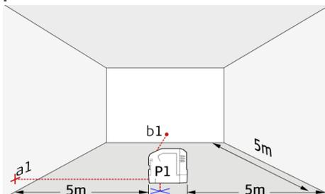
Coloque el interruptor de bloqueo en la posición "Desbloqueado» (vea [Bloqueo de nivelación](#)). Marque un punto de referencia (P1) a unos 5 m de las paredes y coloque el punto de plomada inferior exactamente sobre él. Alinee la cruz con la pared izquierda y marque el punto de intersección (a1) aproximadamente a la misma altura que P1 respecto a la pared. Poco después marque el rayo perpendicular derecho (b1) en la pared frontal.
