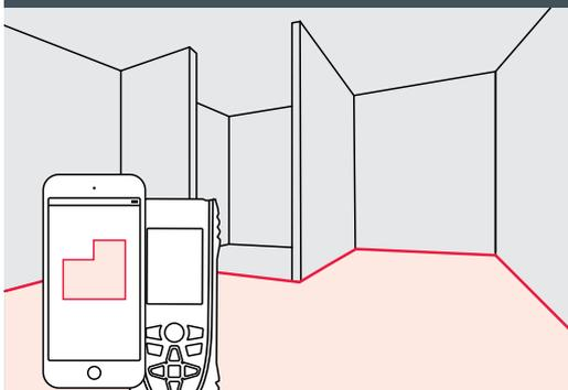
El Leica DISTO™ X3 y X4 en combinación con la aplicación DISTO™ Plan aumenta la eficiencia. Nuevas tecnologías permiten a los dispositivos mantener un registro de mediciones de distancia y el ángulo entre dos de estas mediciones al mismo tiempo. La aplicación transforma luego esta información en planos de planta precisos en su tableta o smartphone.
