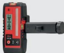
Un receptor láser para todo. Carcasa resistente IP 65 con display frontal y trasero, incl. imanes para sujeción al techo. Localización de rayos láser rojos y verdes a distancias de hasta 80 m. Para Leica Lino L2, L2G, L2P5, L2P5G, L4P1, L6R y L6G. N.º de art. 866 090
