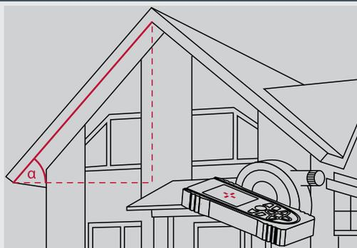
Con esta innovadora tecnología puede medirse la distancia entre dos puntos cualesquiera de modo fácil y rápido desde una posición. Los nuevos tipos de sensor utilizados por el Leica DST 360 y la base Smart del Leica DISTO™ S910 utilizan información de ángulo para hacerlo posible.
