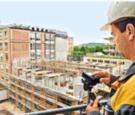
La mira telescópica integrada permite señalar puntos de medición a gran distancia con total seguridad, incluso con condiciones de luz desfavorables.
